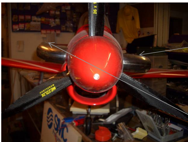
Bild 8 zeigt das Abgasrohr
