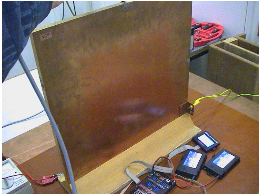
Prüfaufbau für indirekte Entladung Test set-up for indirect discharge
